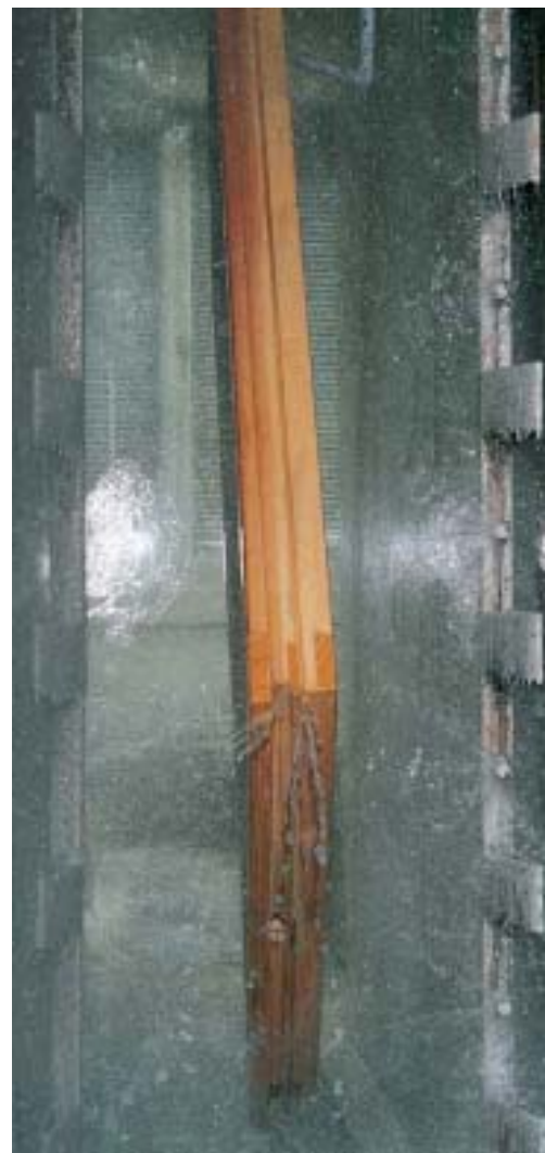
Нанесение пропитки методом обливания.
