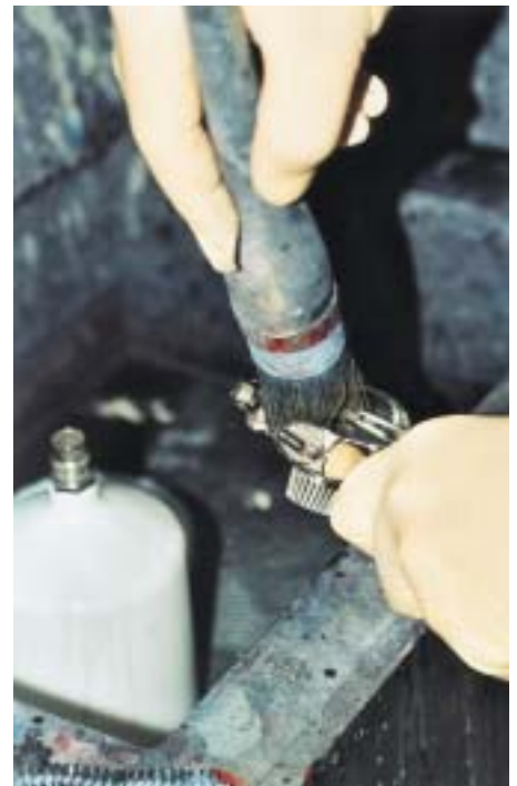
■ Vor dem Zerlegen kommt die Außenreinigung. Das „Innenleben“ wird anschließend so lange mit (frischer!) Verdünnung gespült, bis nur noch klare Flüssigkeit austritt (unten).
