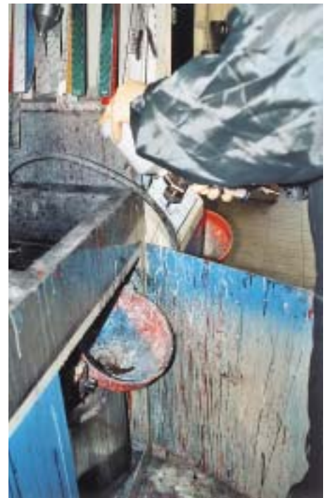
■ Vor dem Zerlegen kommt die Außenreinigung. Das „Innenleben“ wird anschließend so lange mit (frischer!) Verdünnung gespült, bis nur noch klare Flüssigkeit austritt (unten).
