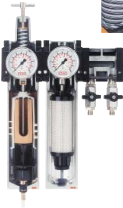
■ Effiziente Filterkombinationen halten Partikel bis 0,01 µm Größe zurück. Bei einer Druckdifferenz >1 bar zwischen Ein- und Ausgangsdruck ist auch bei ihnen Wartung angesagt. Der Sinterbronzeeinsatz kann regeneriert werden, der Mikrofaser-Feinfilter (rechts) ist ein „Wegwerf-Artikel“.
